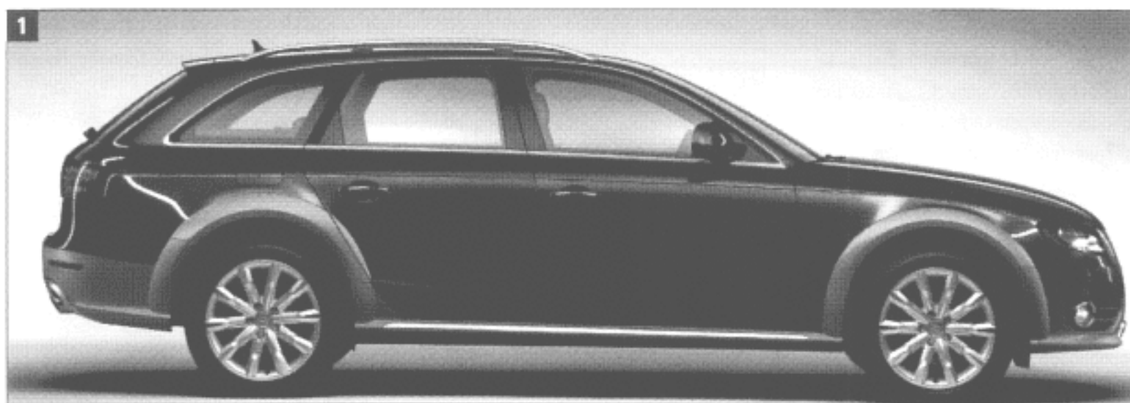
Avant als Offroader: Die um vier Zentimeter erhöhte Bodenfreiheit, der Kunststoff-Kantenschutz und die Edelstahl-Unterfahrschutzbleche ermöglichen härtere Geländeausflüge, als man mit einem normalen Audi-Allradkombi wagen würde.
