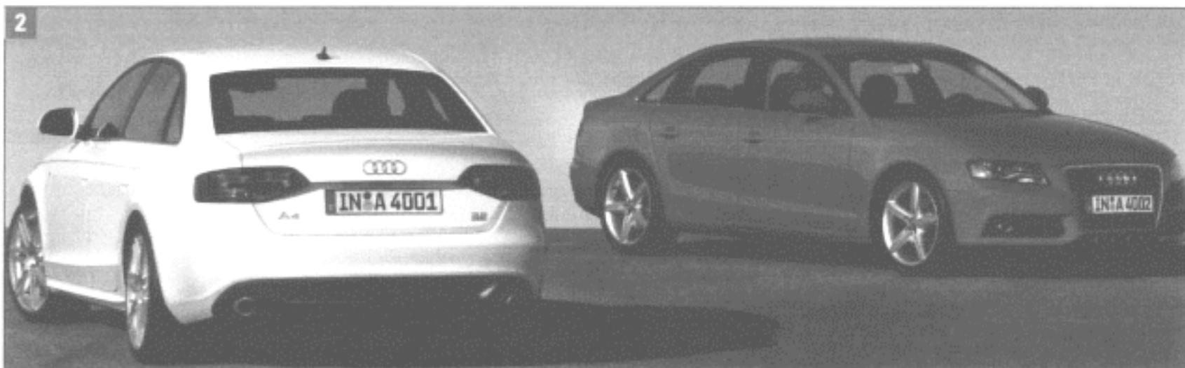
**Großes Fahrzeug:** Beim »Neuen« wurde der vordere Überhang verkürzt, Motorhaube und Radstand wuchsen deutlich. Mit 4703 mm Länge, 1826 mm Breite und 1427 mm Höhe ist der A4 eine große Limousine. Farblich sind die Uni-Lackierungen Ibisweiß und Brillantrot (Bilder) sowie Brillantschwarz und zwölf Metallic- und Perleffekt-Lacke erhältlich.
