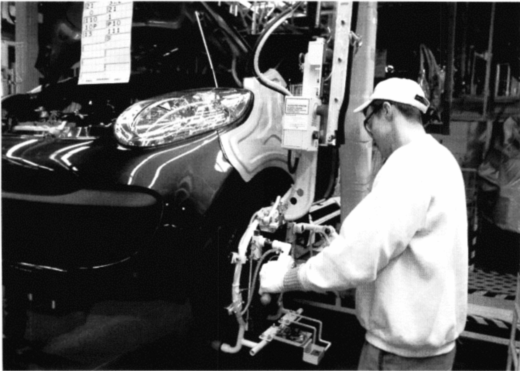
Montagelinie: Die Fertigung der Kleinwagen ist in die drei Hauptbereiche Karosseriebau, Lackiererei und Endmontage unterteilt. Beim Produktionssystem übernahm Toyota die Federführung, der Einkauf liegt in der Hand der PSA Gruppe.
