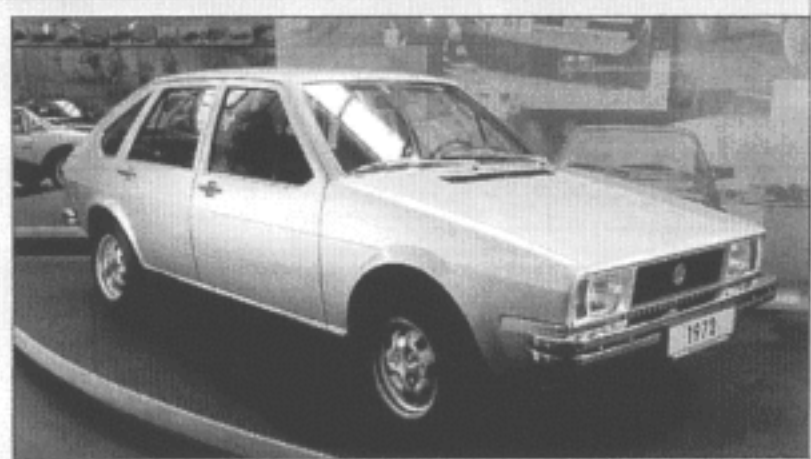
Prototyp EA 272: Zugunsten einer rationellen Fertigung innerhalb des Volkswagen-Konzerns entschied sich der Vorstand letztlich für die Übernahme des Audi 80-Konzeptes: Der daraus resultierende Passat erschien 1973 mit längs angeordnetem Motor als Typ 80-Parallelmodell, dem Giugiaro ein attraktives Fließheck modelliert hatte
