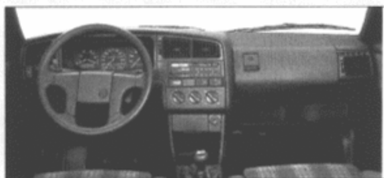
Quereinsteiger: Die Queranordnung des Antriebsaggregats schaffte im Innenraum äußerst großzügige Platzverhältnisse
