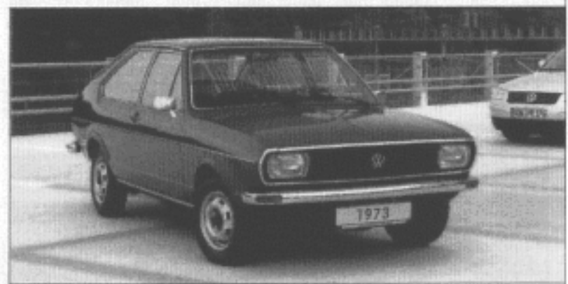
Prototyp EA 272: Zugunsten einer rationellen Fertigung innerhalb des Volkswagen-Konzerns entschied sich der Vorstand letztlich für die Übernahme des Audi 80-Konzeptes: Der daraus resultierende Passat erschien 1973 mit längs angeordnetem Motor als Typ 80-Parallelmodell, dem Giugiaro ein attraktives Fließheck modelliert hatte
