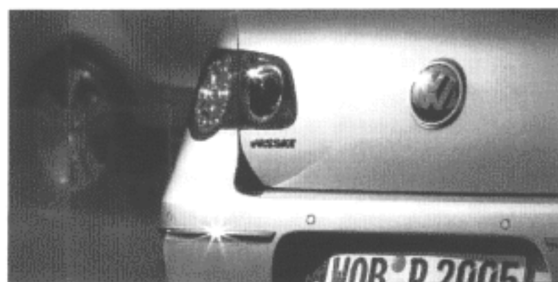
Aufwendige LED-Technik: Serienmäßig strahlen im Dunkeln und beim Bremsen nun viele Leuchtdioden
