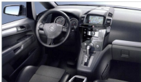
Offener Koffer Das Sechsstufen-Automat mit Winterprogramm-, SportShift- und ActiveSelect-Optik ist ab 88 kW (120 PS) CDTI verfügbar.
