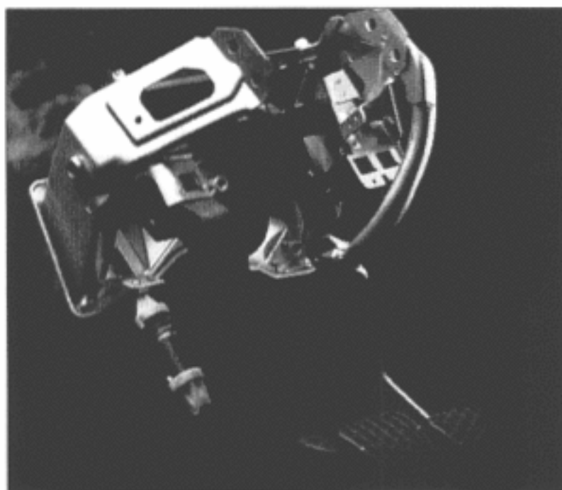
»Fällt« bei einem Frontalcrash in den Fußraum: Die Meriva-Pedalerie.
