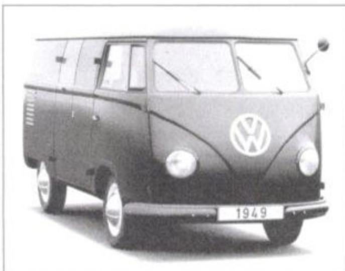
November 1949: Der erste Transporter wird vorgestellt. Sein luftgekühlter 1,2 Liter Boxermotor leistet 18 kW.
