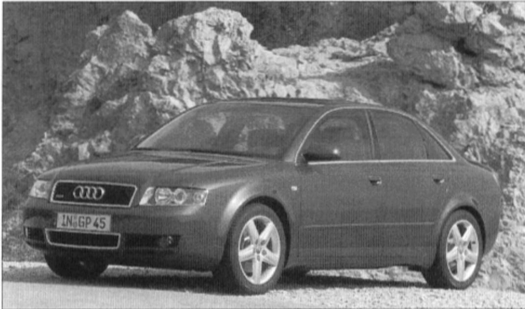
Ein  $c_w$ -Wert von nur 0,28 und die in dieser Klasse herausragende Torsionssteifigkeit zeichnen die A4-Karosserie aus. Der Kühlergrill unterstreicht die Zugehörigkeit zur aktuellen Audi-Design-Linie.
