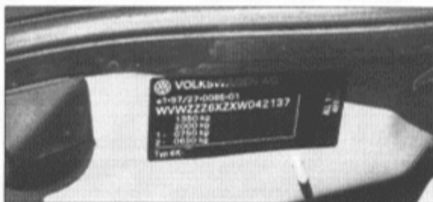
Das Typschild mit der Fahrzeug-Identifizierungsnummer befindet sich im Motorraum an der hinteren Querwand rechts.
