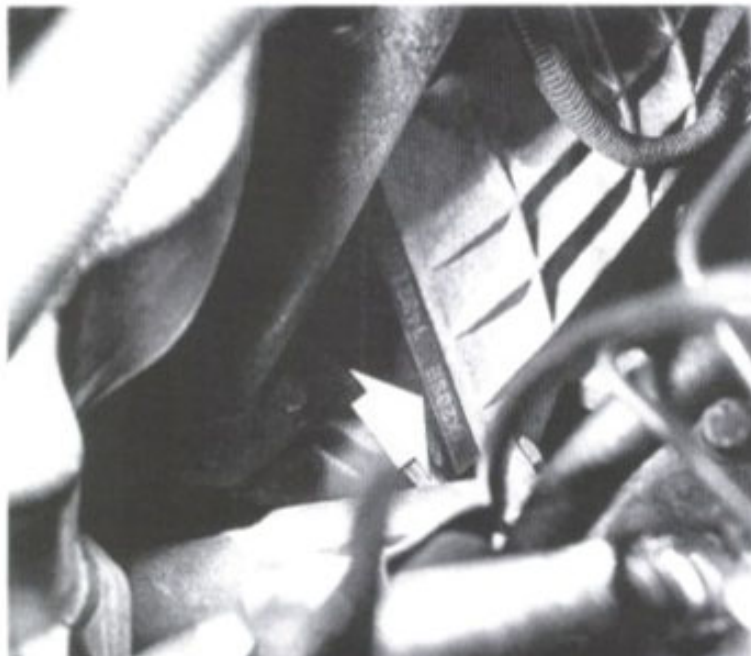
Die Abbildung zeigt die links hinten am Motorblock eingeschlagene Motor-Typbezeichnung mit der nachfolgenden Motornummer eines Achtventilmotors.
