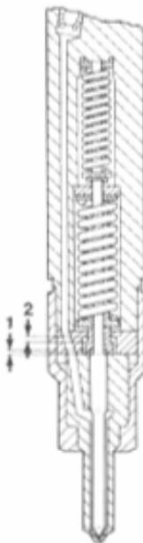
Hier ein Schnitt durch eine Zweifeder-Düse des TDI-Motors. Die Maßpfeile und Zahlen symbolisieren die Ventilhübe für Hub -1- und Hub -2-. Der Kraftstoff wird bei dieser Düse gewissermaßen in zwei Raten eingespritzt, also nicht schlagartig für die Verbrennung zur Verfügung gestellt. Das Ergebnis ist ein ruhigerer Motorlauf; das Direkteinspritzer-Nageln wird weiter unterdrückt.
