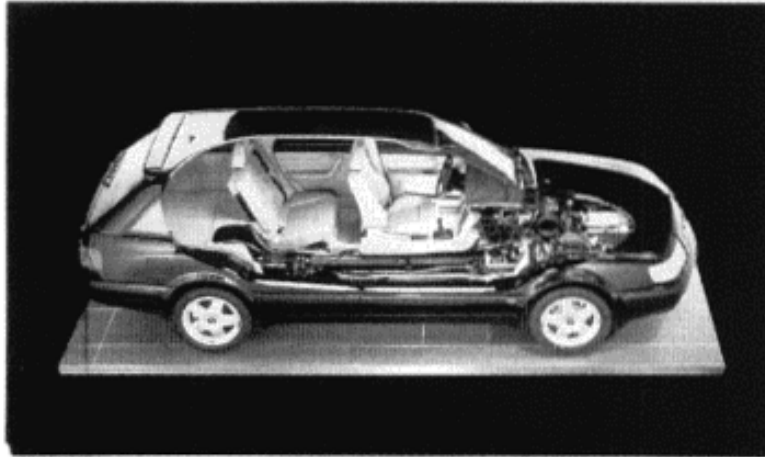
Das Schnittmodell des Audi 100 Avant läßt Einblicke zu auf die Innenraumgestaltung und den Antriebsstrang des quattro-Modells.
