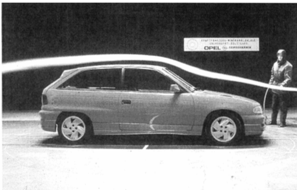
Der Astra steht gut im Wind. Hier wird im Windkanal der Universität Stuttgart anhand von Rauchfahnen der Weg des Windes sichtbar gemacht.
