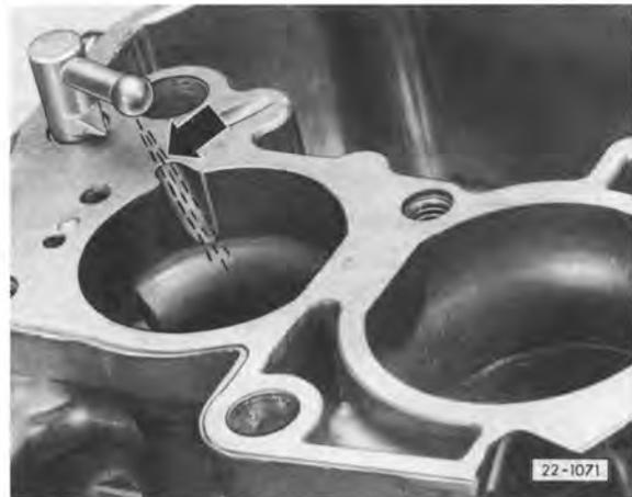
Der Kraftstoffstrahl muß in Richtung Aussparung abspritzen –Pfeil–.
