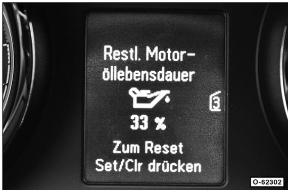
Um die Zeit bis zur nächsten Wartung ungefähr abschätzen zu können, besteht die Möglichkeit, sich im Display des Kombiinstrumentes die bisher errechnete »**Restliche Lebensdauer**« des Motoröls über das Fahrzeug-Informations-Menü anzeigen zu lassen, siehe dazu auch das Kapitel »Service-Intervall-Anzeige zurücksetzen«.
