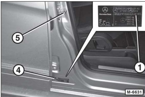
Die Fahrgestell-Nummer –1– steht auch auf dem Typschild –4– unterhalb des Türschließzapfens –5– der Beifahrertür.
