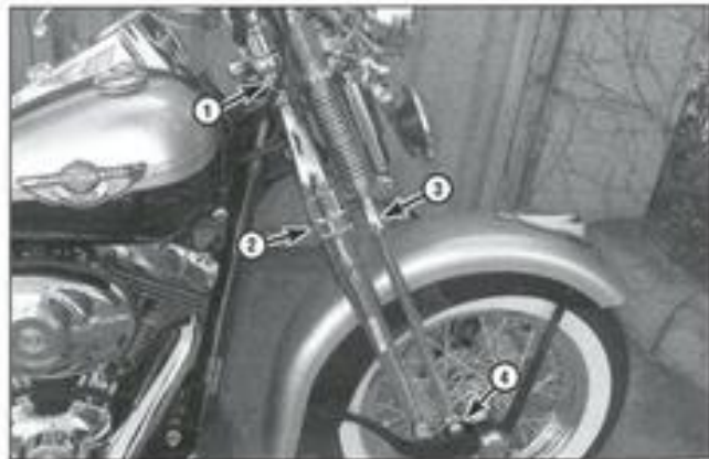
6.5b Bauteile der Springergabel (gezeigt an einer FLSTS) 1 Lenkschaft 2 feste Gabel 3 Federgabel 4 Schwinghebel
