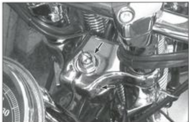
6.5a Lockern Sie die Gabelbrücken-Klemmschraube, und entfernen Sie die Hutmutter samt Gummischeibe.
