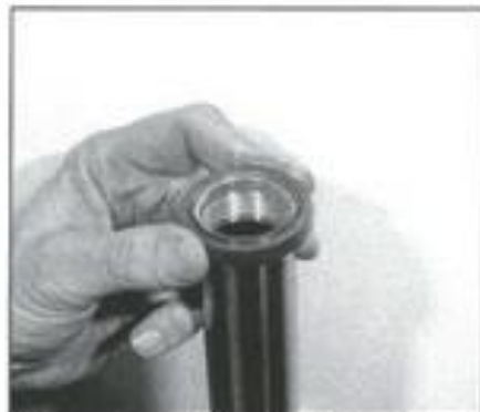
4.27b ... dann wird er mit der Beschriftung nach außen vorsichtig über das Standrohr geschoben.
