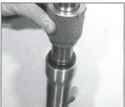
4.29 Treiben oder drücken Sie die Staubkappe in ihren Sitz im Tauchrohr.
