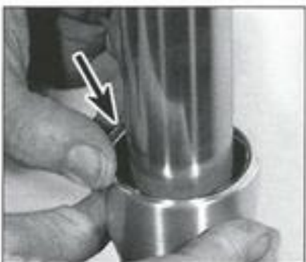
4.28 Drücken Sie den Sicherungsring vollständig in die Nut über dem Dichtring.
