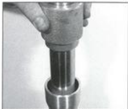
4.27c Treiben Sie den Dichtring so weit ein, bis rundherum die Nut sichtbar ist.
