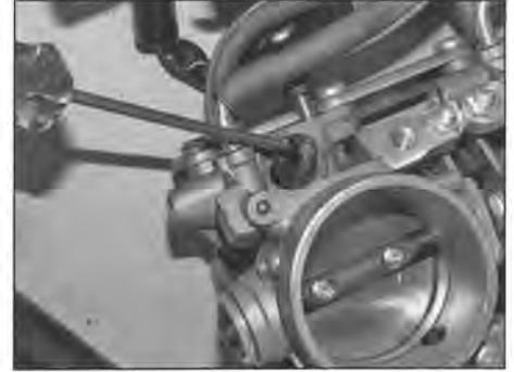
9.8 Entfernen Sie die Dichtungen.
