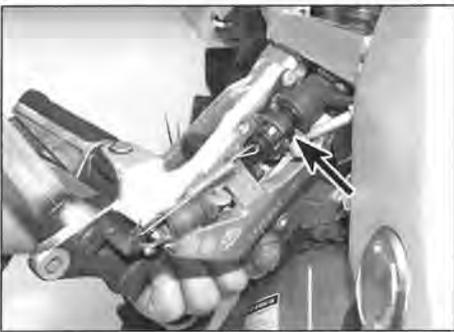
**1.12c** ... um Zugang zur Einstellmutter des Bremslichtschalters zu erhalten.
