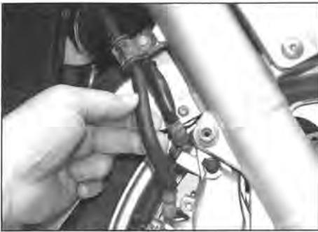
**1.10** Alle Schläuche, Rohre und Anschlüsse müssen auf Risse und Lecks untersucht werden.
