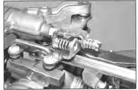
10.5c Reinigen und kontrollieren Sie alle Teile der Standgasanhebung.
