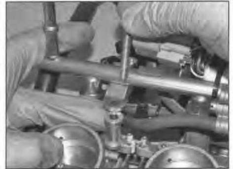
9.13 Installieren Sie die Distanzstücke zwischen das Verteilerrohr und die Drosselklappengehäuse.
