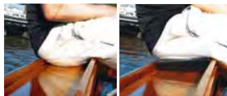
Ohne Brett (links) drücken Fußleiste und Stüll in Schenkel und Gesäß, mit Brett ist es eine Ebene
