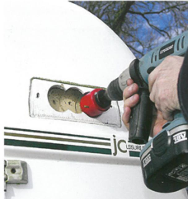
**9** Zuvor befand sich in der Wand nur ein Lüftungsloch. Wir montieren einen größeren Lüfter mit Rollo.
