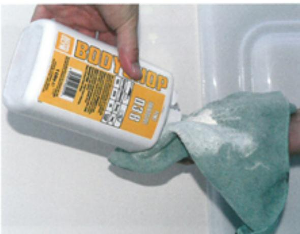
**8** Dann folgt stundenlange Handarbeit mit feiner Politur und schließlich eine Beschichtung mit einer Super-Harzpolitur. Sie versiegelt die Oberfläche und erzeugt einen hellen Glanz.
