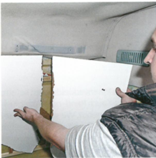
**1** Wir bringen die Verkleidung in einem Wohnwagen der Marke Freedom an. Seine Wände sind aus glasfaserverstärktem Kunststoff. Insofern ist das kein typischer Fall. Wir entfernen zuerst das Innere des alten Bads. Dann befestigen wir die Holzleisten mit Schrauben und Leim.
