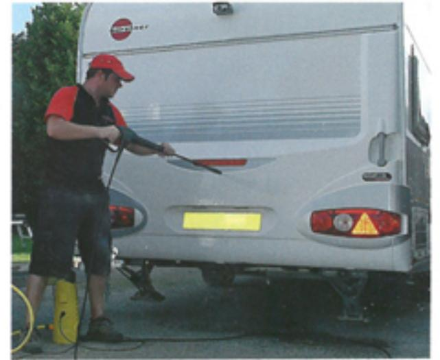
**3** Dann spritzt er die Karosserie mit seinem speziellen Niederdruckreiniger ab (Hochdruck könnte Schäden verursachen), entfettet sie gleichzeitig und bereitet sie so auf die folgende Behandlung vor.
