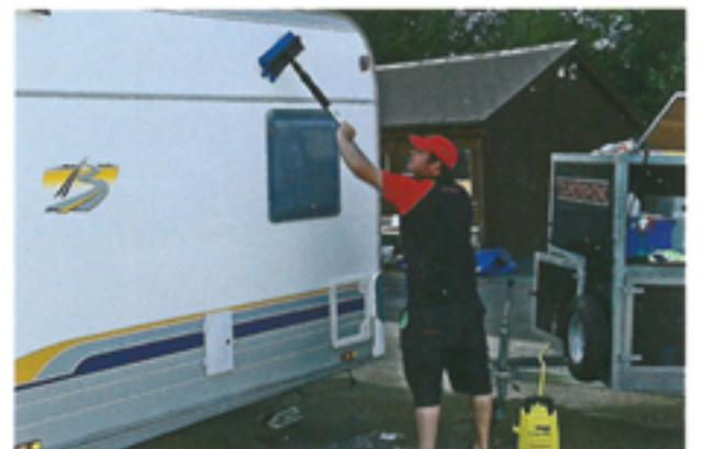
**5** Wenn die Oberfläche nicht zu schlecht aussieht, kann man sie anstelle der Niederdruckreinigung bürsten. Danach trocknet Paul die Oberfläche mit einem Mikrofasertuch ab und entfernt dabei das gesamte Wasser.
