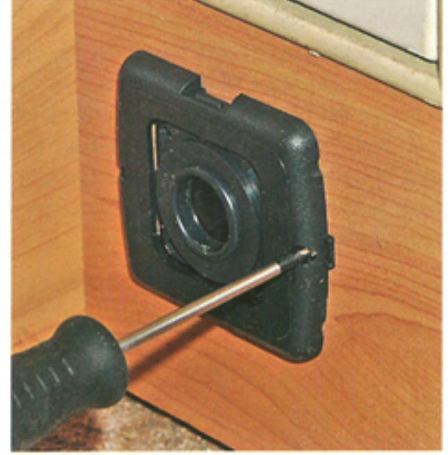
**9** Dann folgt der innere Rahmen (c in Bild 1). Er wurde mit ähnlich kurzen Schrauben festgeschraubt. Die Schraubenköpfe müssen in das Formteil des Rahmens einsinken.
